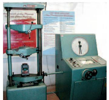
Пресс - испытания на прочность
