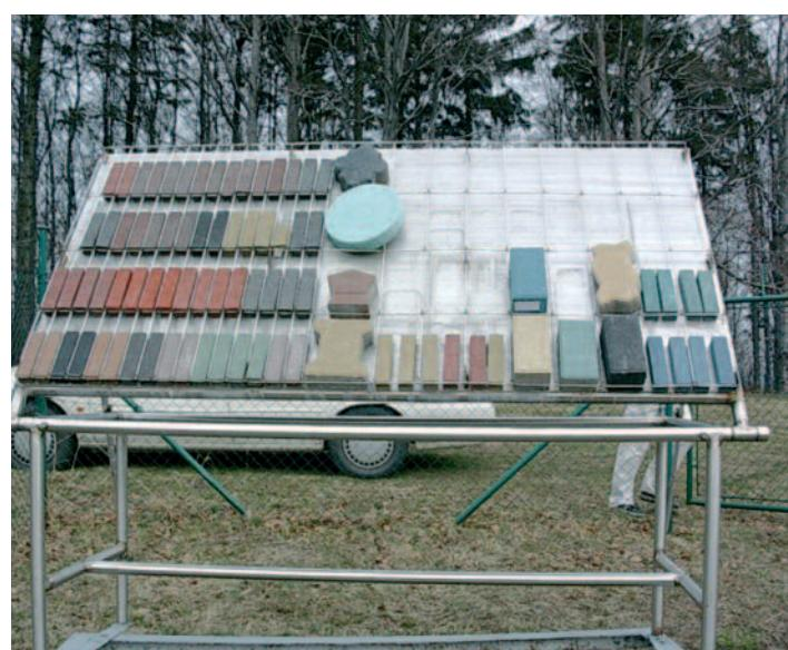
Части станции для измерения воздействия погодных условий (пигменты Fepren в цветном бетоне и титановые белила – нанесенные на листовой металл)
