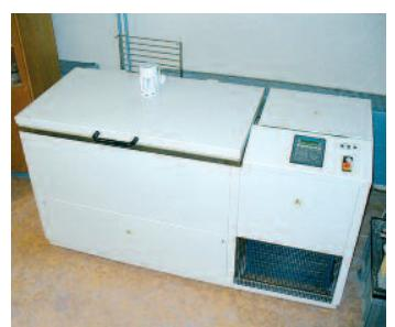
Прибор для определения стойкости к химическому размораживающему веществу.
