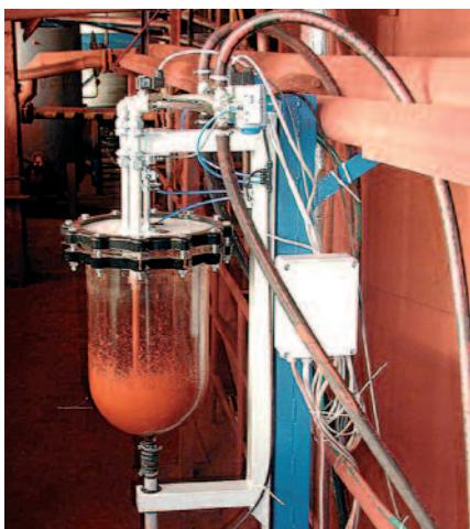
Дозатор для дозировки жидких красок
